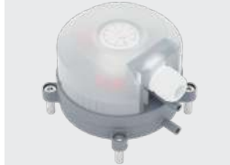
Differenzdruckwächter mit potentialfreiem Kontakt zur Signalisierung der Filterverstopfung.
