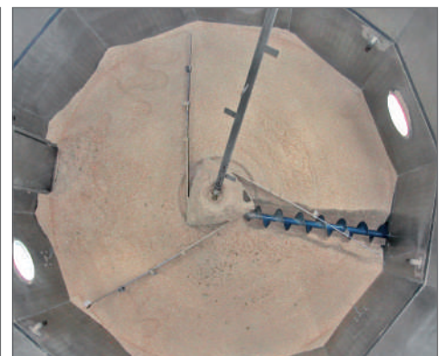
SBANCATORE A BALESTRE EXTRACTEUR À LAMES RESSORT SPRING ARMS CONVEYOR AUSTRAGSVORRICHTUNG DESBANCADOR CON BALLESTA
